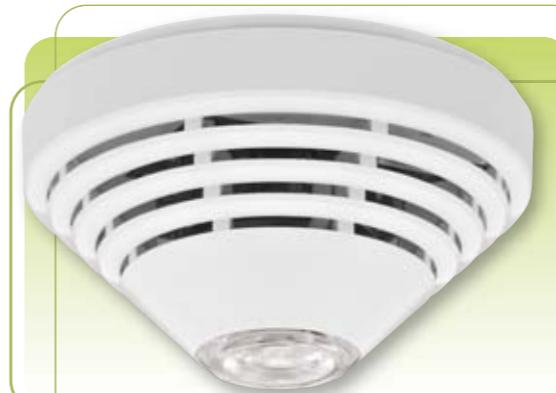
Der Glasbruchmelder **JA-85B** erkennt Luftdruckveränderungen in Verbindung mit dem Geräusch von brechendem Glas. Er wird gegenüber des entsprechenden Fensters montiert und besitzt einen Erfassungsbereich von max. 9 Metern.
